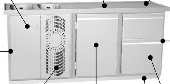
**Isolierkorpus**, absolut kältebrücken und 100% FCKW-frei hochdruckverschäumt; Wände innen komplett in Edelstahl, außen aus starkem verzinktem Stahlblech, Isolierstärke 50 mm
